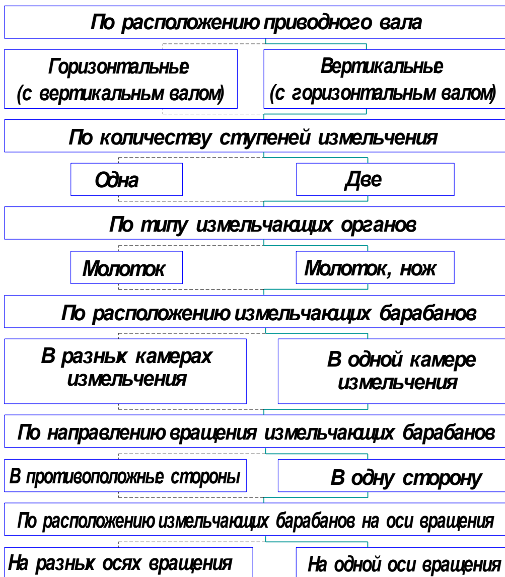
Рис. 3 – Классификация дробилок с указанием направления разработки
